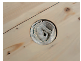
3. Situation de transport avec la sangle enroulée dans l'encoche
