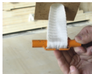
3. Mettre la broche avec l'agrafe de sécurité vers le bas et la garder dans cette position
