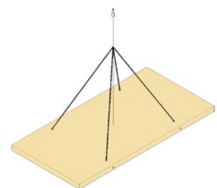
2. Mise en oeuvre avec le système de levage de montage
