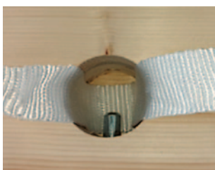
1. Insérer la sangle et la broche dans l'usinage
